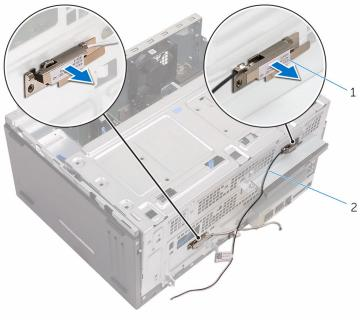
1 antenna modules (2) 2 antenna cables (2)
